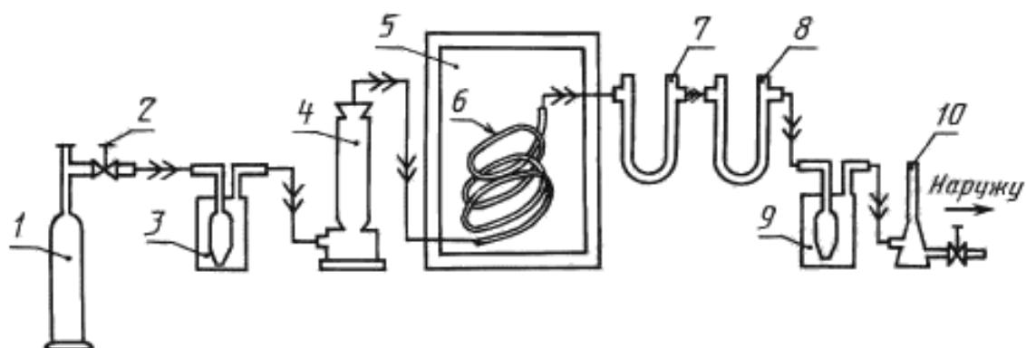
Баллон, заполненный азотом, содержащим не более 0,5 % объема кислорода.
