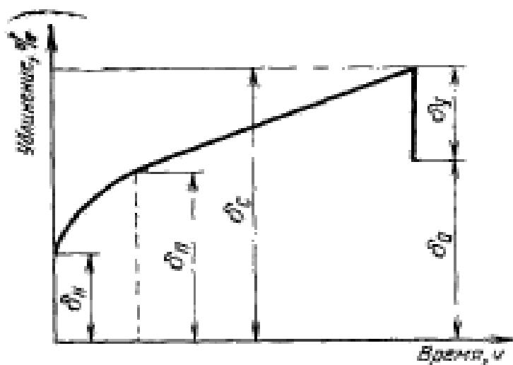
$\delta_m$ —удлинение при нагружении;  $\delta_p$ —полное (упругое + остаточное) удлинение на криволинейном участке;  $\delta_e$ —суммарное (упругое + остаточное) удлинение за время испытания;  $\delta_y$ —упругое удлинение;  $\delta_o$ —остаточное удлинение
