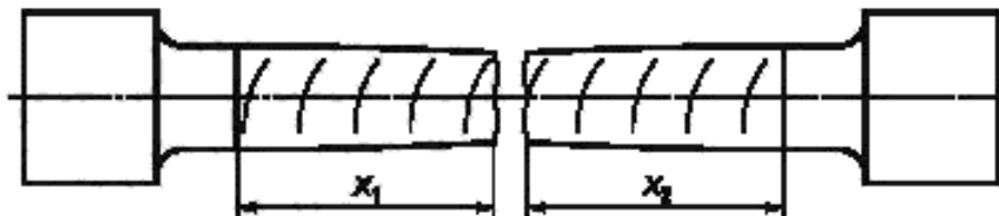
Рисунок 4 — Область проверки L в образце для испытания на растяжение металла шва
