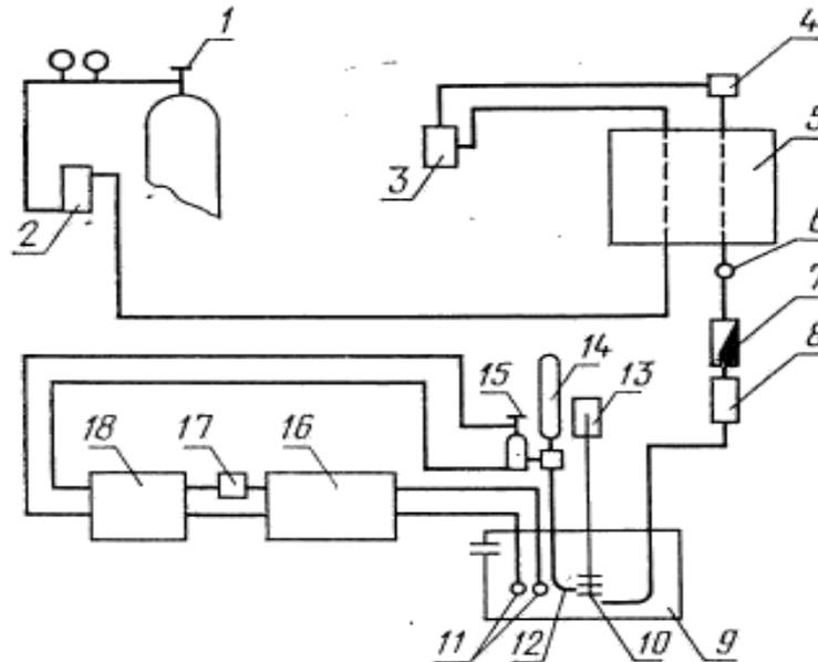
**Примечание.** Вместо бюретки 14, магнитного клапана 15 можно использовать автоматическую бюретку-дозатор Б-701.
