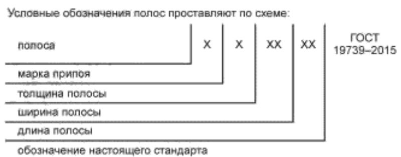
Пример условного обозначения полосы из серебряного припоя марки ПСр 45, толщиной 1,6 мм, шириной 100 мм, длиной 200 мм:
